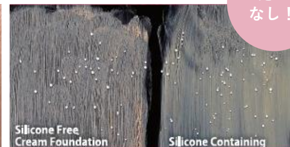
サンプル塗布後、ビーズを散布し、塗布板を立てて ビーズを落とした後の状態
