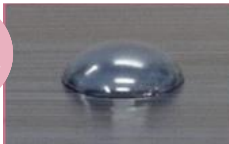
サンプル塗布面に水を垂らした後の 水滴の状態
