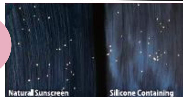
サンプル塗布後、ビーズを散布し、塗布板を立てて ビーズを落とした後の状態
